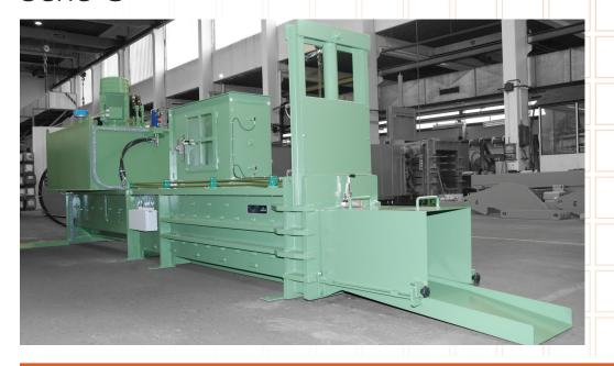
La prensa S1W, de funcionamiento totalmente automática, es particularmente adecuada para prensar latas de aluminio y hierro en paquetes altamente comprimidos. Estas prensas se caracterizan por su construcción, rendimiento, vida útil y eficacia.
